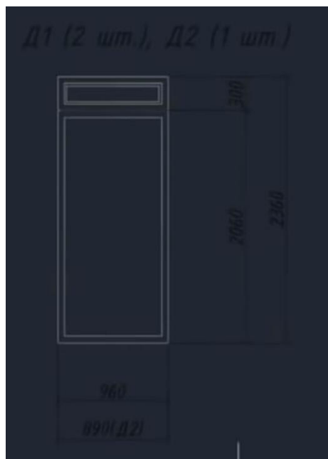
5-расм. Эшик конструкцияси
