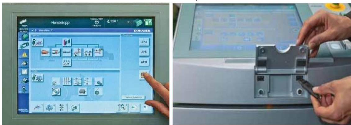
13-расм. Сомет а) ва Dornier б) тўқув дастгоҳларини электрон назорат панели*
