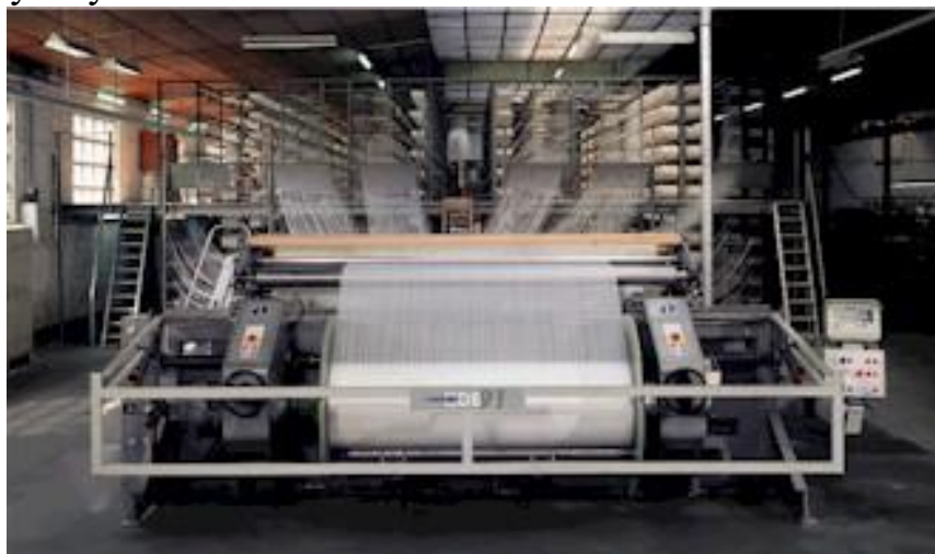
5.-расм SDB91-300 русумли гуруҳлаб тандалаш машинаси
