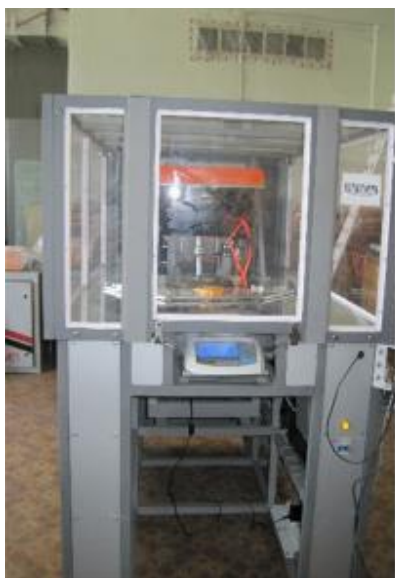
24-расм. АВХС-01 автоматлаштирилган пахта намлигини ўлчаш прибори ва бошқарув пултининг умумий кўриниши
