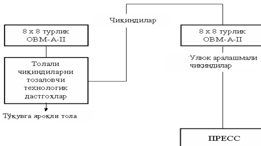
15-расм. Толали чиқиндиларни тозалашнинг технологик схемаси
