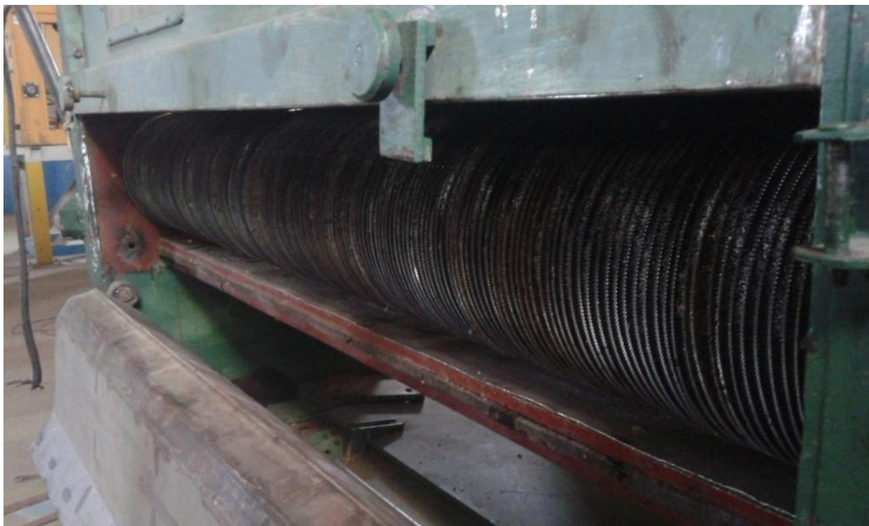
28-расм. Комбинацияланган арра-металл чўткали цилиндрнинг умумий кўриниши
