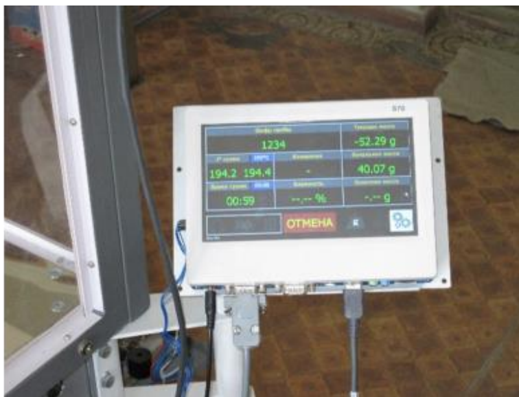
24-расм. АВХС-01 автоматлаштирилган пахта намлигини ўлчаш прибори ва бошқарув пултининг умумий кўриниши
