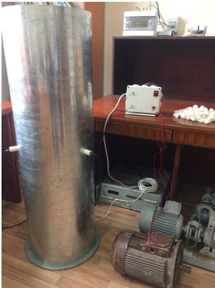
30-расм. Ёнғинни автоматик аниқлаш қурилмасининг стенд нусхаси.
