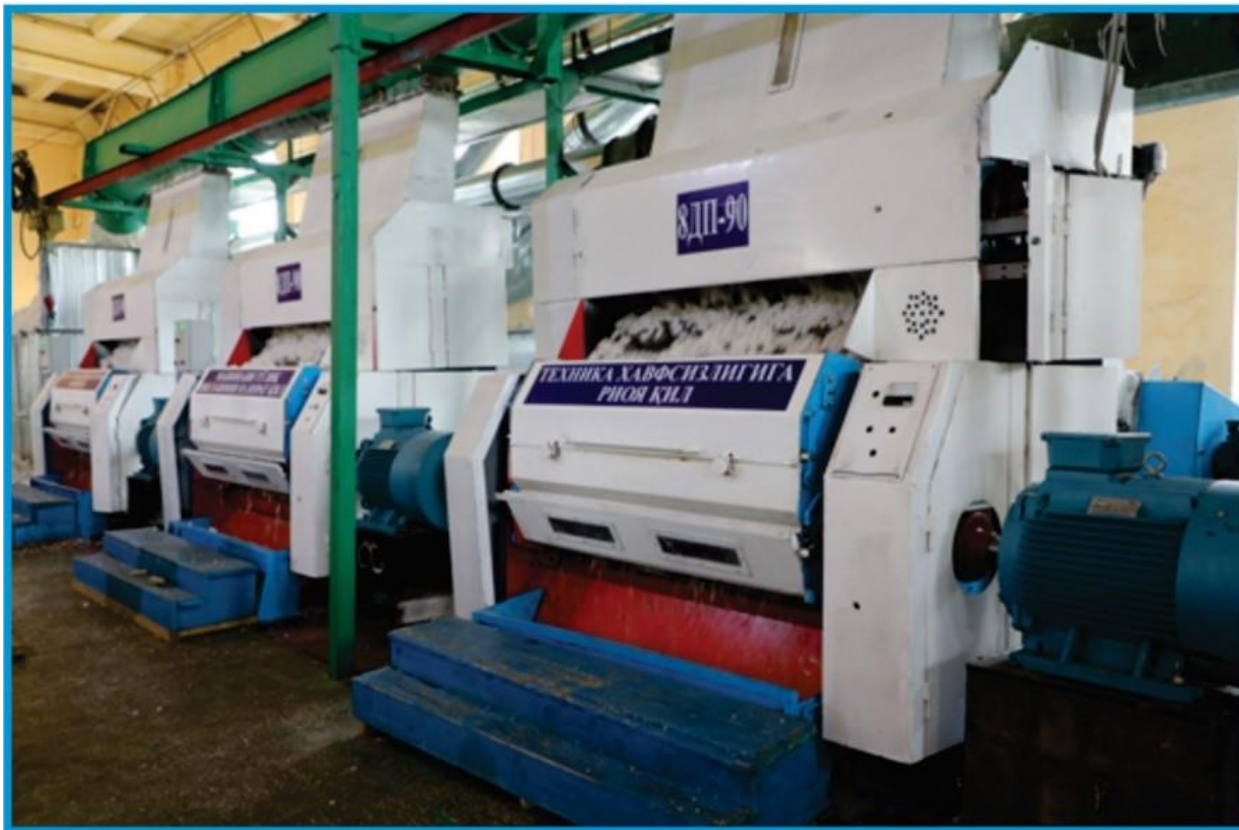
27-расм. 8ДП-90 русумли аррали жин ускунасининг умумий кўриниши
