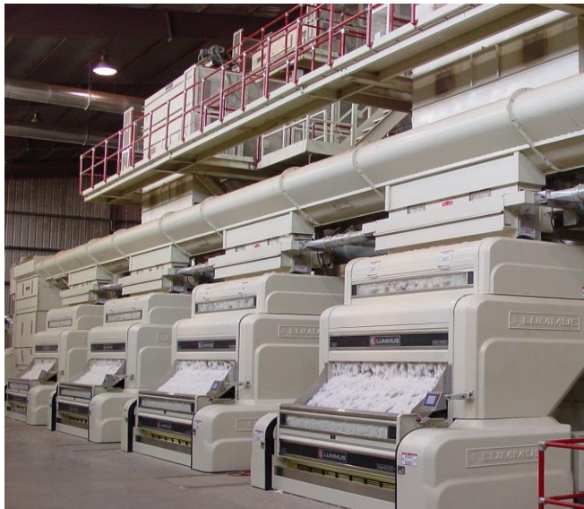
4.2-расм. Аррали жинлар ўрнатилган қаторнинг умумий кўриниши
