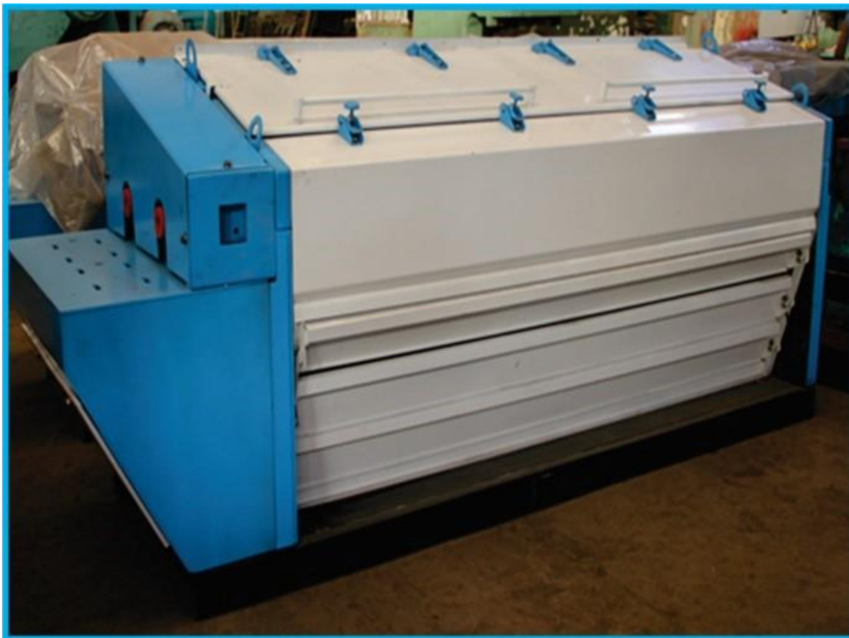
26-расм. 5ВП русумли икки барабанли тола тозалагичнинг умумий кўриниши
