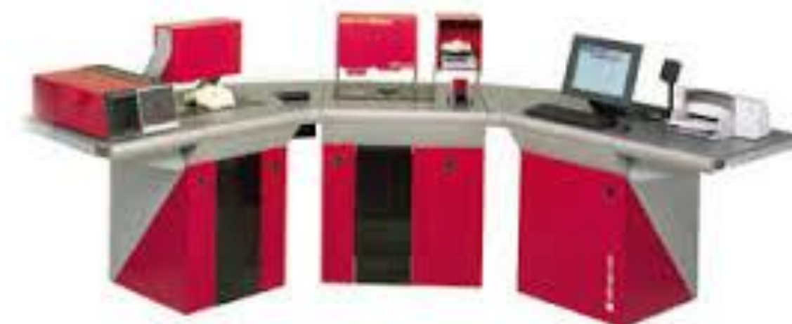
16-расм. HVI тизимининг асосий модуллари
