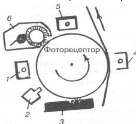
3.4-расм. Heikon DCP 320D машинасининг босиш секцияси схемаси:
