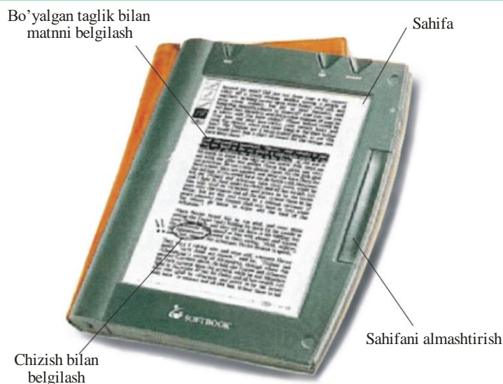
4-расм. Бошқарув панелига эга бўлган электрон китоб, фойдаланиувчи китобнинг исталган қисмларини белгилаши мумкин (Softbook, Softbook Press)
