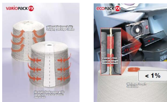
39-расм. Variopack FX керакли ҳажимда ва Ecopack FX керакли узунликда ипни ўраш
