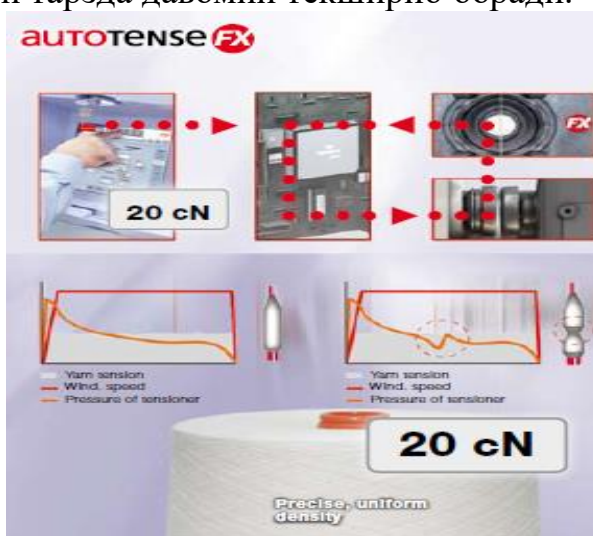
38-расм. Autotense FX тарангликни ростлаб ипни ўраш
