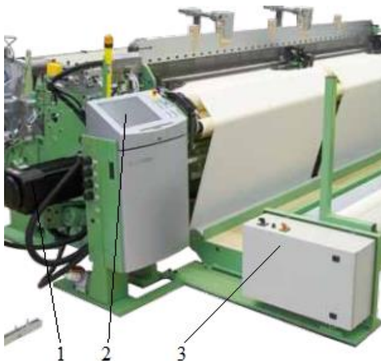
16-расм. DORNIER тўқув дастгоҳи 1- DORNIER SyncroDrive мотори, 2-бошқарув панели, 3-электрокути.*
