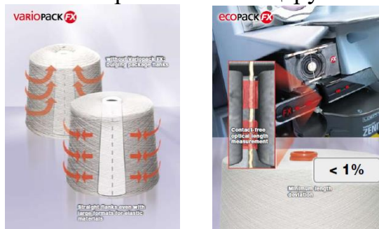
3.31-расм. Variopack FX керакли ҳажимда ва Есораск FX керакли узунликда ипни ўраш
