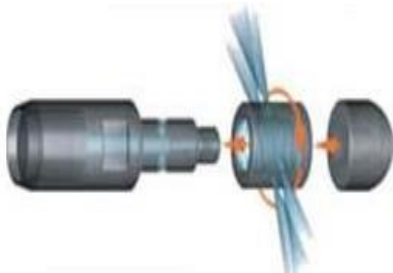
3.2-расм. Ҳаво уярма (Vortex) усулида ип ишлаб чиқариш техноложик жараёнлари.
