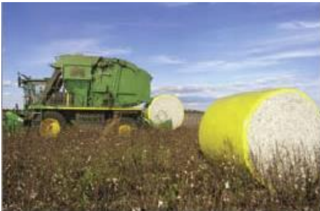
17-расм. СР690 русумли пахта териш комбайини ва ундан пахтани модул чиқариш жараёни
