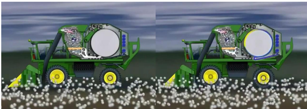
13-расм. Машина комбайнида пахта модули тайёрлаш жараёни
