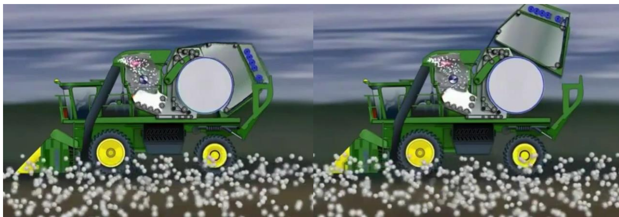
13-расм. Машина комбайнида пахта модули тайёрлаш жараёни
