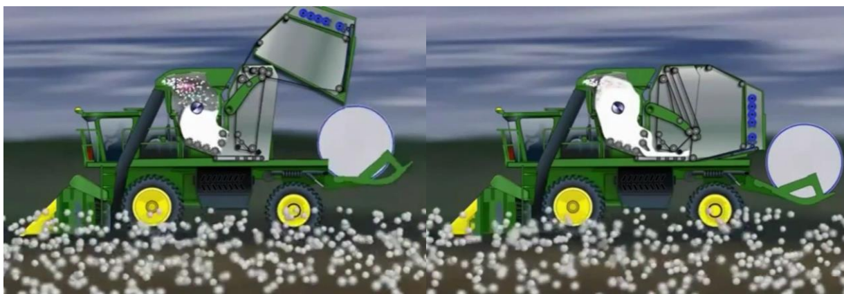
14-расм. Машина комбайнида тайёрланган пахта модулини чиқариш жараёни
