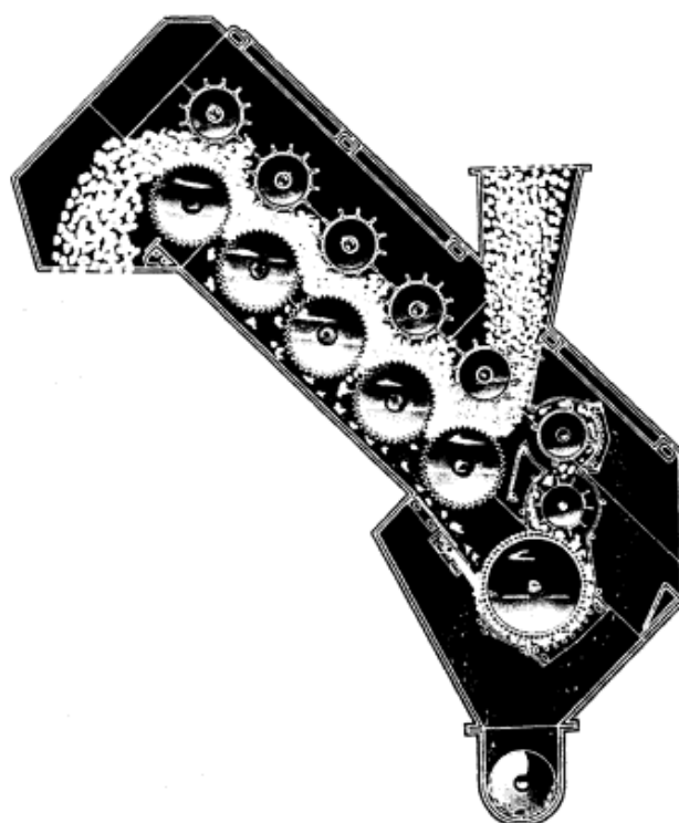
30-расм. “Continental Eagle” корпорациясининг қозикчали-аррачали барабанли қия тозалагич схемаси
