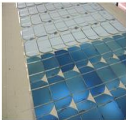
29-расм. 36 та ҚЭ ташкил топган коммутацияланган занжир (чапдан), икки қатламли герметизация пленкаси (EVA) ва бир қатламли ҳимоя пленкаси (ПЭТ) (ўнгдан)
