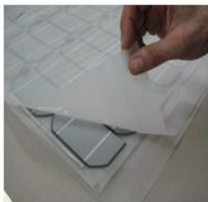
29-расм. 36 та ҚЭ ташкил топган коммутацияланган занжир (чапдан), икки қатламли герметизация пленкаси (EVA) ва бир қатламли ҳимоя пленкаси (ПЭТ) (ўнгдан)
