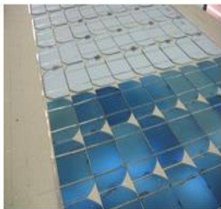
29-расм. 36 та ҚЭ ташкил топган коммутацияланган занжир (чапдан), икки қатламли герметизация пленкаси (EVA) ва бир қатламли химоя пленкаси (ПЭТ) (ўнгдан)
