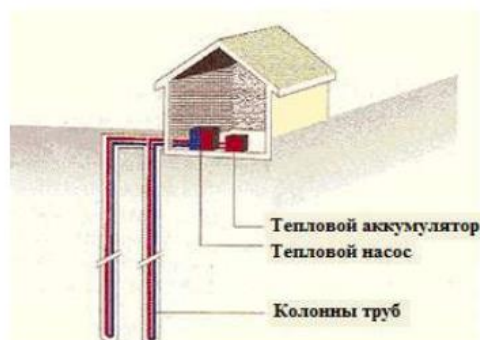
2. Расм. Иссиқлик алмашинувига эга паст чуқурликдаги геотермал тизим
