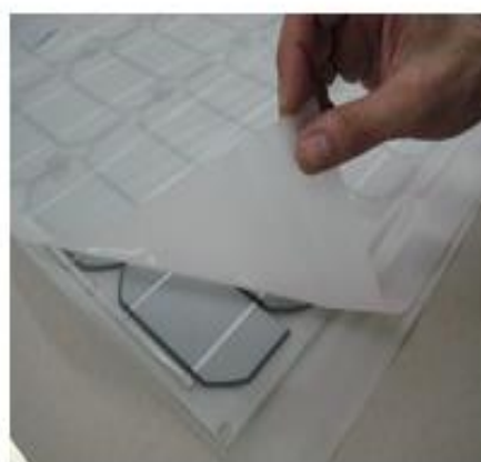
29-расм. 36 та ҚЭ ташкил топган коммутацияланган занжир (чапдан), икки қатламли герметизация пленкаси (EVA) ва бир қатламли химоя пленкаси (ПЭТ) (ўнгдан)
