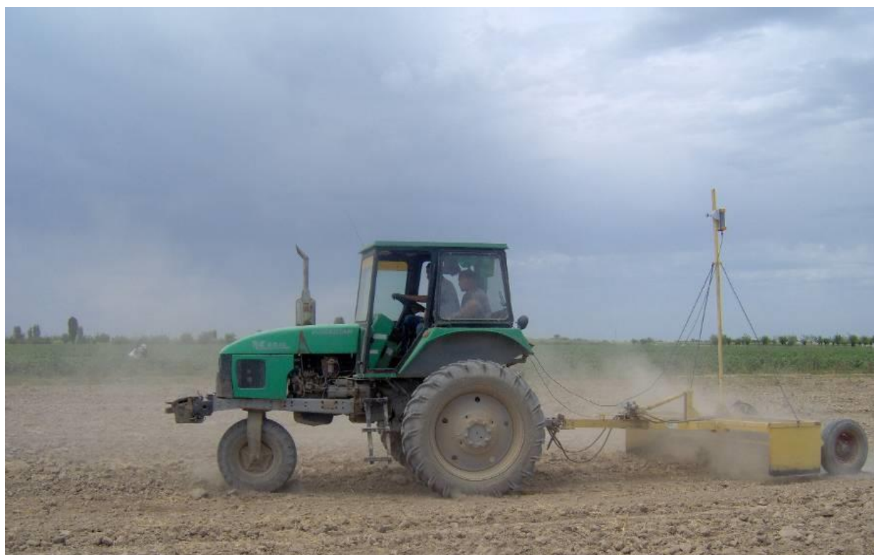
13-расм. Лазер текислагич ёрдамида текислаш ишлари олиб борилмоқда (Трактор ТТЗ-80.10 )
