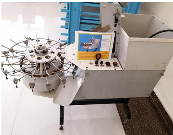
5-расм. Пиллаларни оғирлиги бўйича жинсларга ажратувчи ОПК аппарати.
