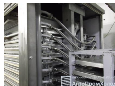
35-расм. Туннел-флюидизацион музлатиш нозик мева ва резаворларни нафис музлатиш учун қўлланилади.
