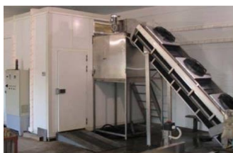
36-расм. Кескин музлатиш мосламаси спираль конвейер чучвара ва бошқа яримтайёр маҳсулотлар учун қўлланилади.
