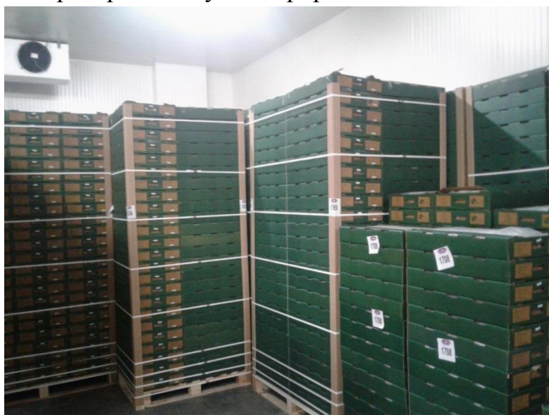
9-расм. Ёғоч тагликларга тахланган қутилардаги маҳсулотни дастлабки совутиш
