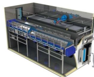
35-расм. Туннел-флюидизацион музлатиш нозик мева ва резаворларни нафис музлатиш учун қўлланилади.
