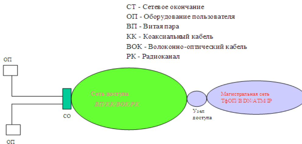
2.2.-rasm. Murojaat tarmog`ining ta`rifi.
