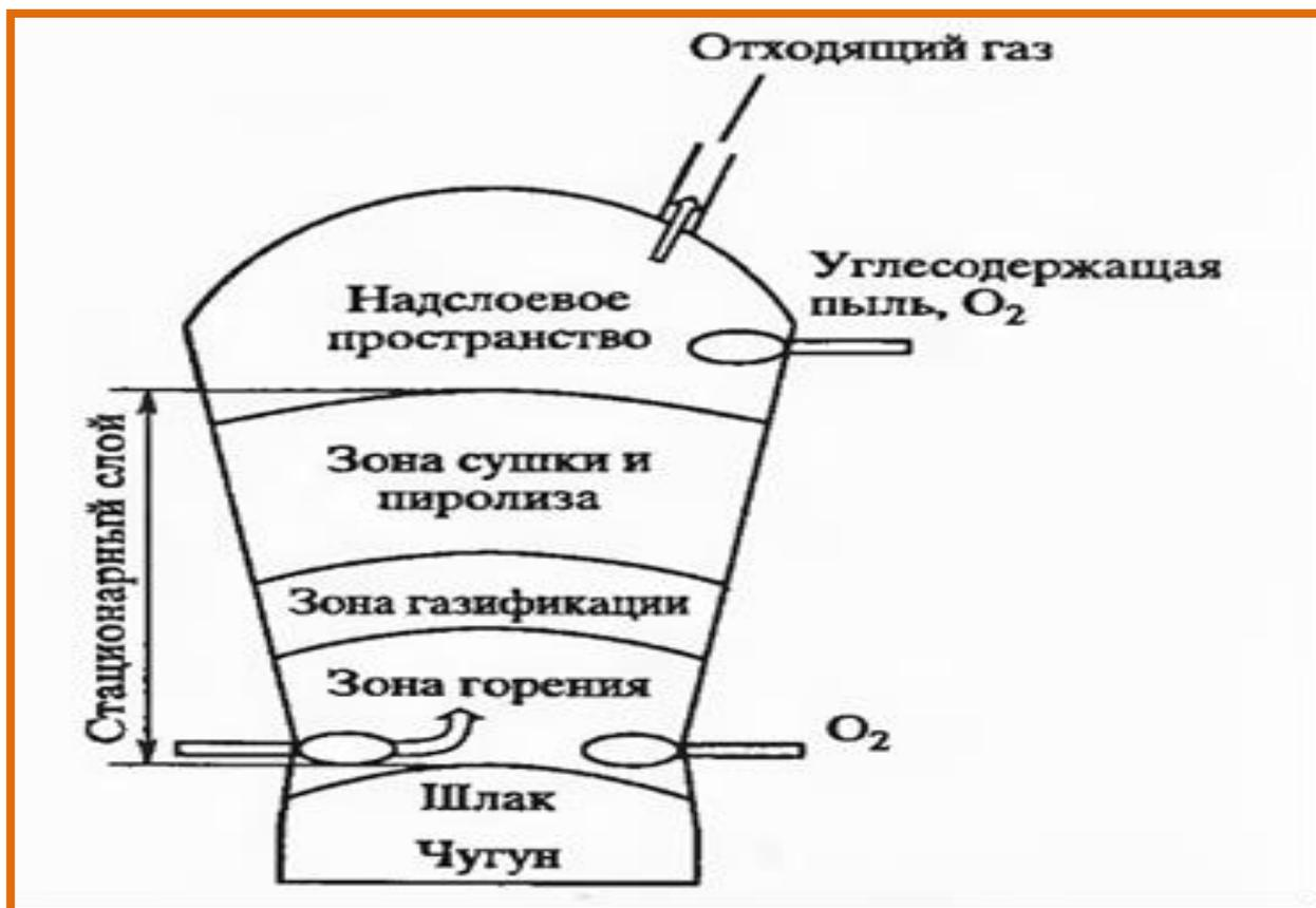
Рис. 2.2. Схема рабочего пространства реактора газификатора COREX
