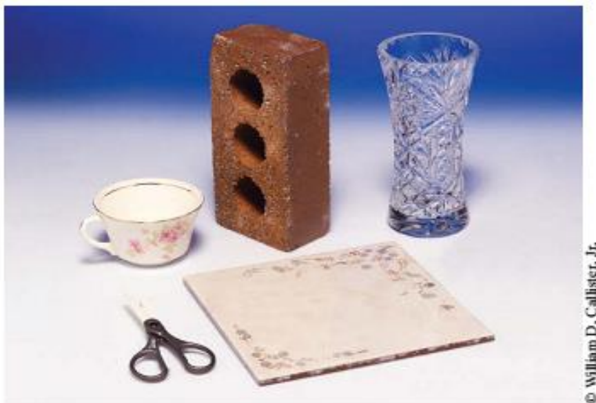
Расм 2.4. Керамик материаллардан тайёрланган оддий махсулотлар – қайчи ушлагичи, чой учун чашка, қурилиш ғишти, таглик ва шиша ваза.
