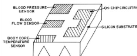
Чип рис. 10—Multisensor со схемой на чипе
