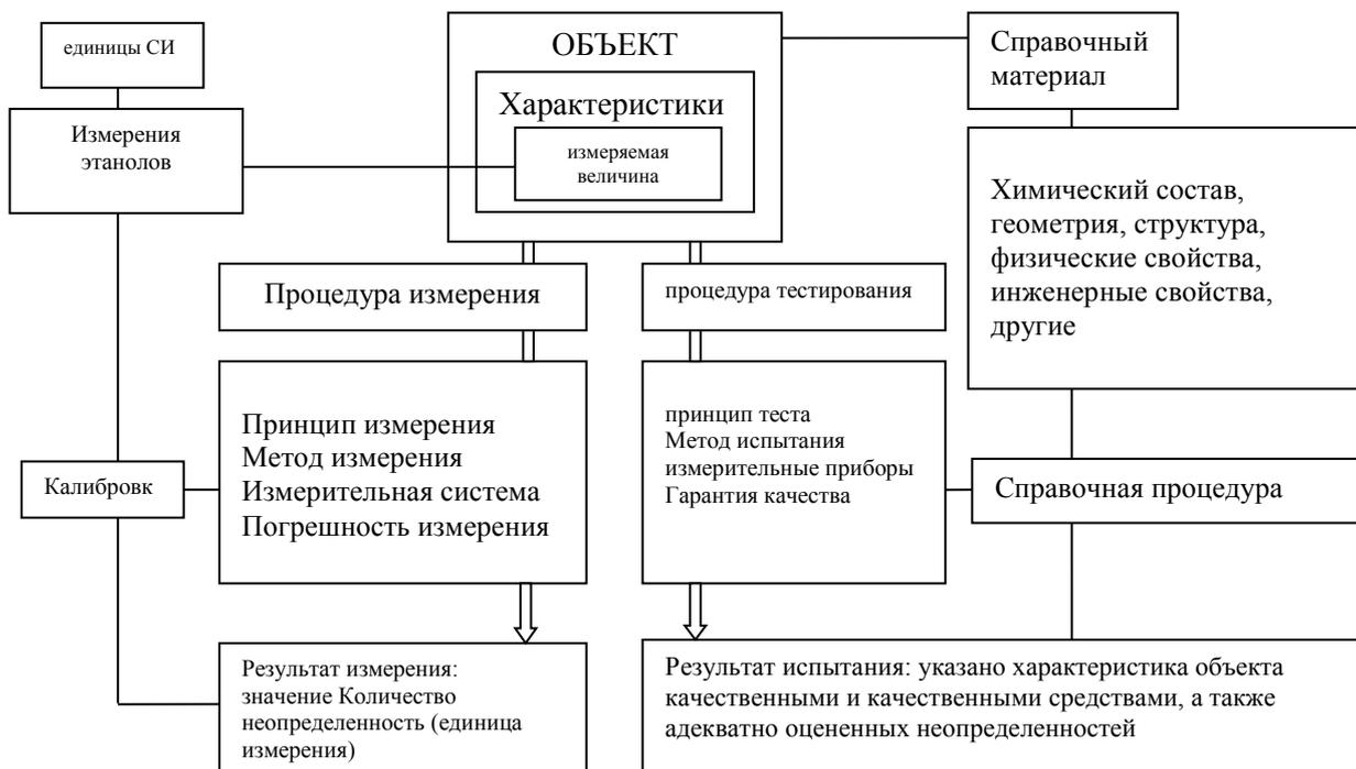
Рис. 1.1 методологии измерения и проверяющий - общая схема
