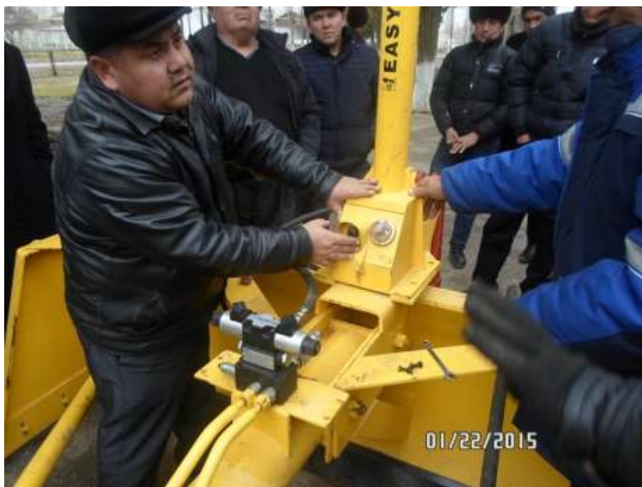
2-расм. Асосий рамага Лазер нурини қабул қилгич (ресивер) мачтасини улаш
