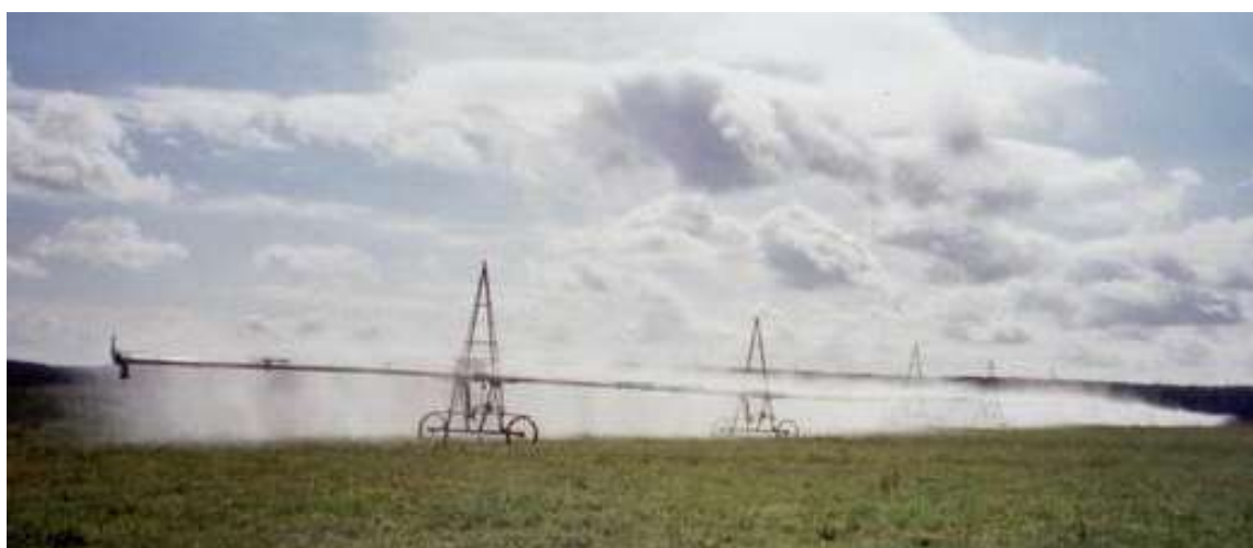
1.1-расм. ТИМИ да лойиҳаланган ва тажриба нусхаси ишлаб чиқарилган ёмғирлатгич машинаси
