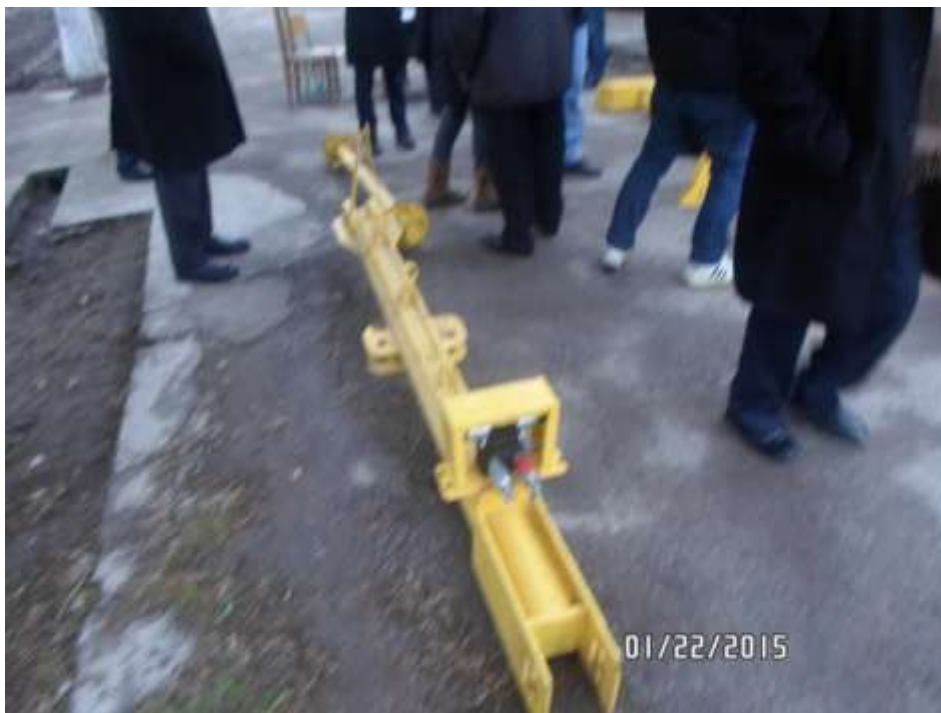
1-расм. Лазер нури ёрдамида бошқариладиган текислагич асосий рамаси
