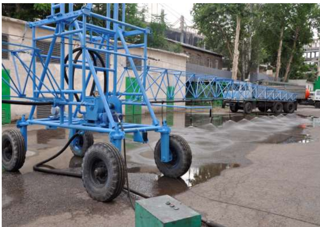
1.1-расм. ТИМИ да лойиҳаланган ва тажриба нусхаси ишлаб чиқарилган ёмғирлатгич машинаси
