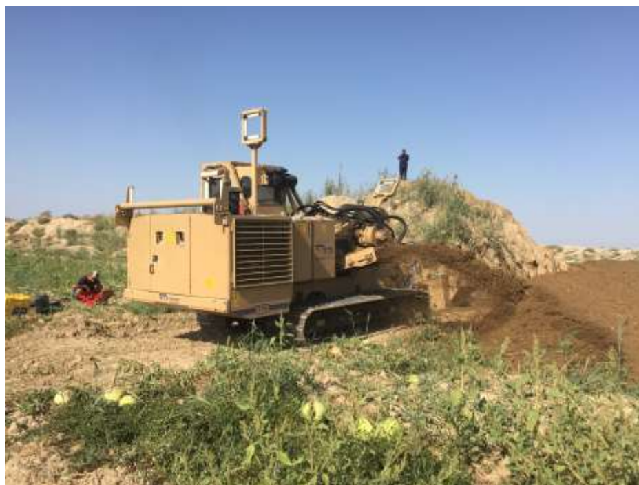
2.1-расм. Италиянинг TESMES компанияси томонидан ишлаб чиқарилган ёпиқ горизонтал дренаж қуриш машинаси умумий кўриниши
