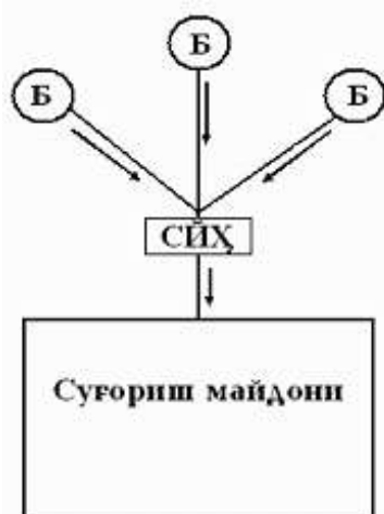
87-расм. Булоқ манба- ларидан суғоришда фойдаланиш схемаси
