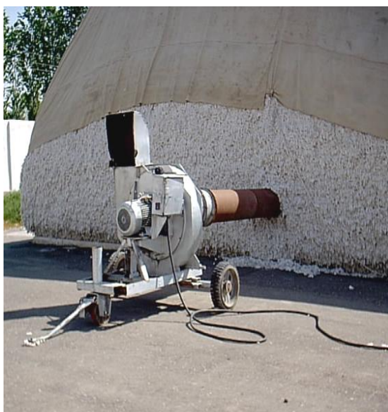
9-расм. УВП русумли кўчма вентиляторнинг ғарамга ўрнатилиши ва қурилманинг тузилиши.
