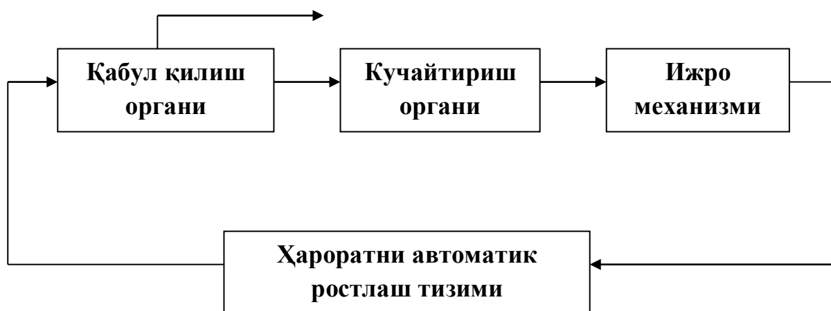
5.2-расм. Теплица шароитида маҳсулот етиштиришда ҳаво ҳароратини автоматик ростлаш тизимининг функционал схемаси.
