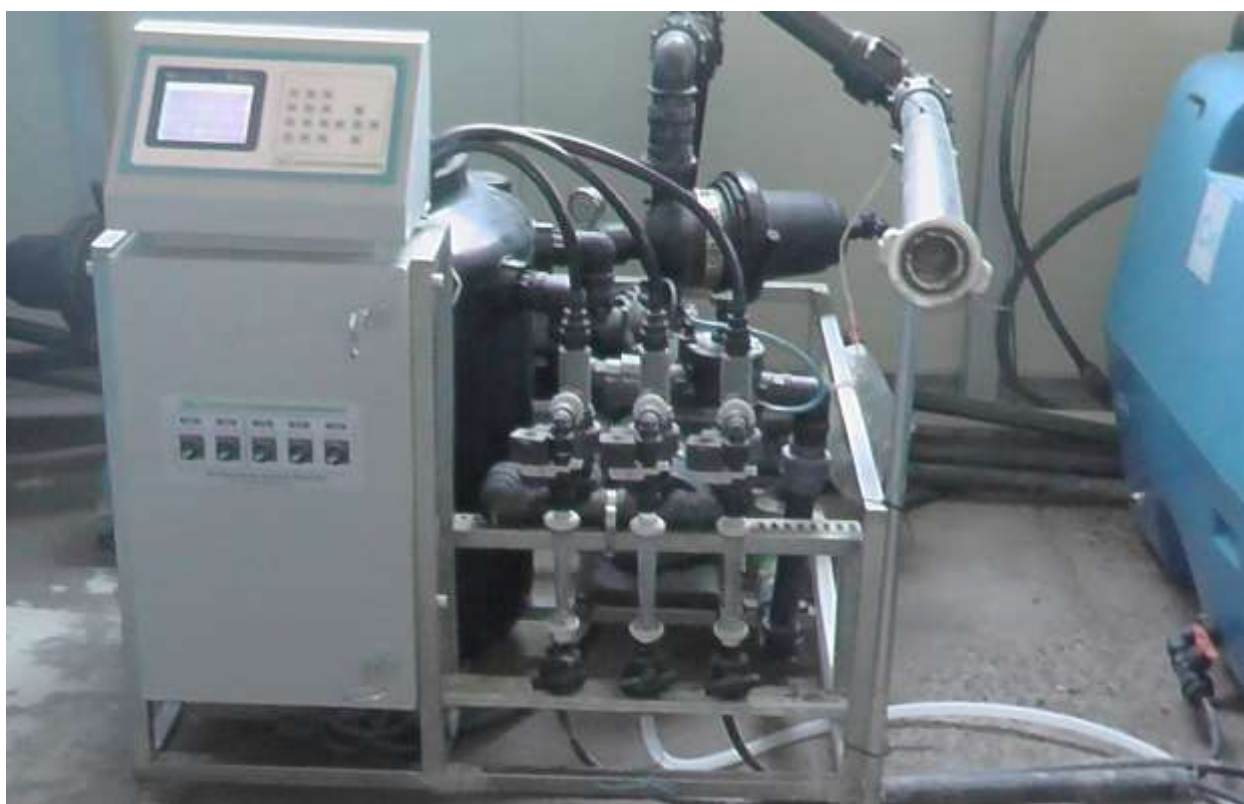
5.14-расм. Теплицада ўсимликларни автоматик озуклантирувчи сенсорли бошқариш
