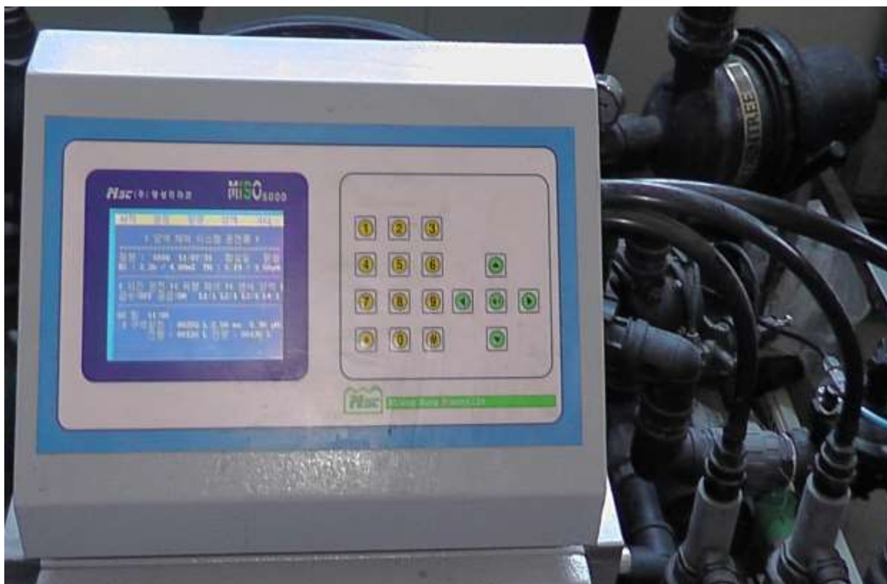
5.15-расм. Теплицада ўсимликларни автоматик озуклантириш миқдорини назорат қилиш
