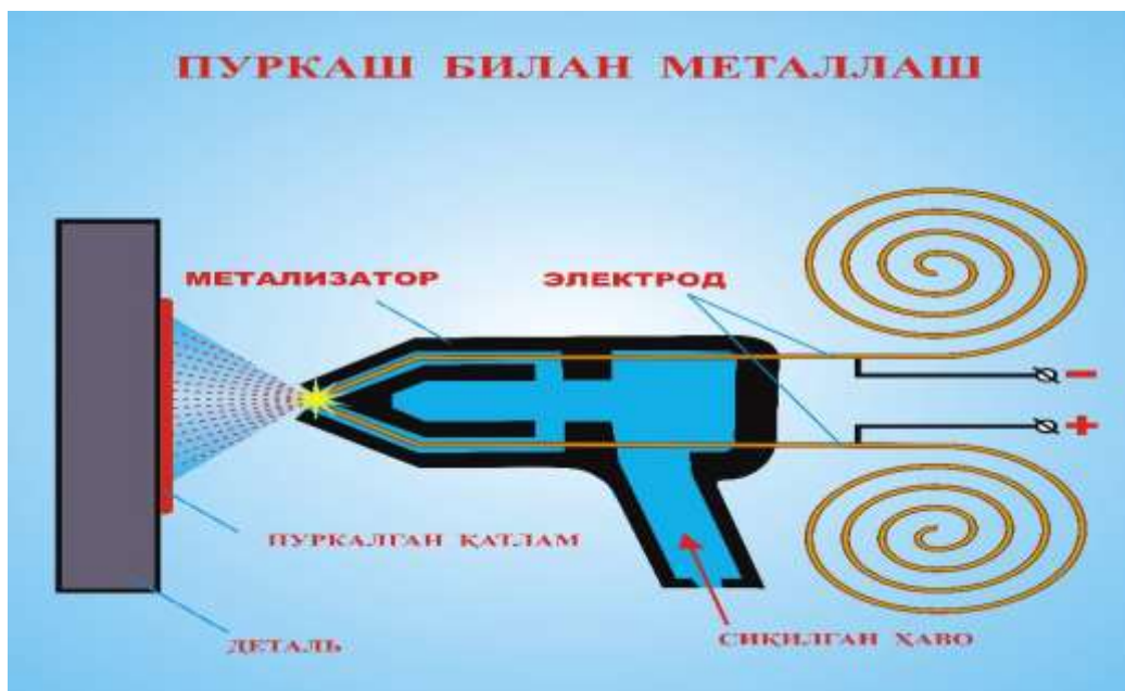
Расм. Электрэйли металлалаш схемаси
