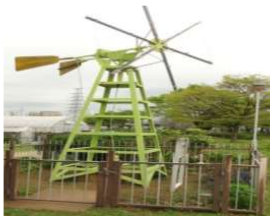
6.5 –расм. Ер ости қудуғидан сув кўтариб бераётган поршенли насосни ҳаракатга келтирувчи шамол қурилмаси.
