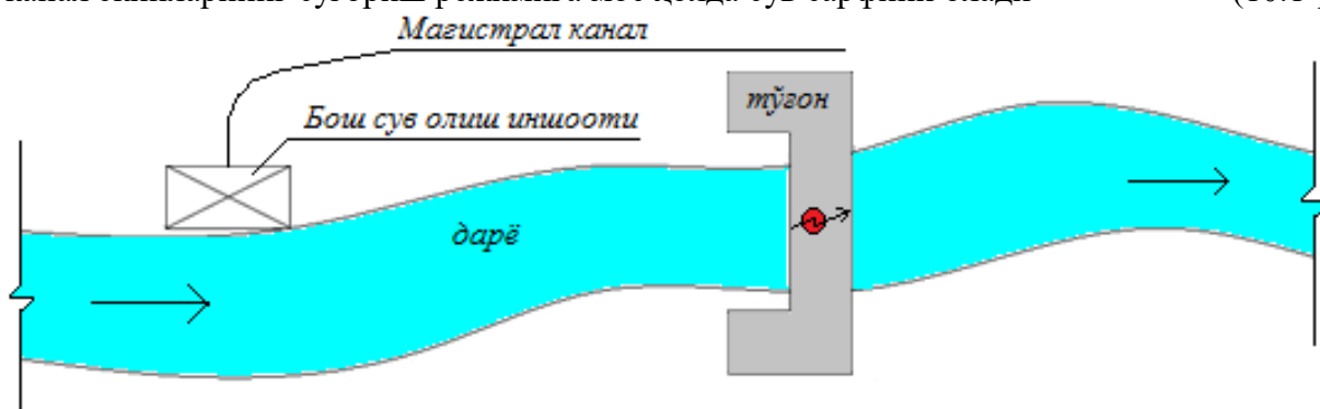
10.1-расм. Дарёдаги сув сатҳини кўтарувчи тўғонга қурилган ГЭС схемаси.
