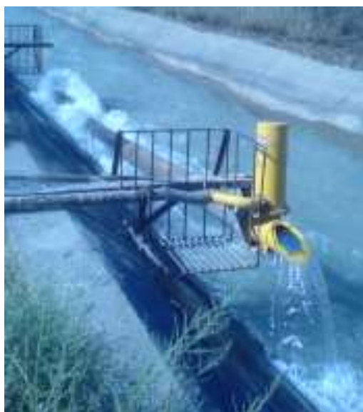
3.7-расм. Канал нишаблиги ҳисобига ўрнатилган гидротаран.
