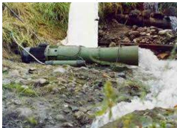
3.4-расм. МикроГЭС 10 Прнинг металл қувурлар (а) ва брезентли қувурлар (б) билан улаб эксплуатация қилиш ҳолатлари.
