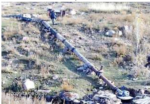
3.4-расм. МикроГЭС 10 Прнинг металл қувурлар (а) ва брезентли қувурлар (б) билан улаб эксплуатация қилиш ҳолатлари.
