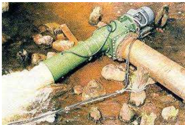
3.4-расм. МикроГЭС 10 Прнинг металл қувурлар (а) ва брезентли қувурлар (б) билан улаб эксплуатация қилиш ҳолатлари.
