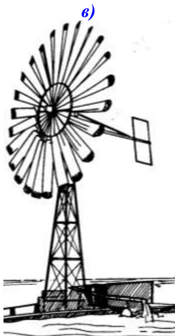
42-расм. Поршенли насосни характга келтирувчи шамол қурилмаси: а,б – ер остидан сув қўтариб берувчи шамол механик қурилмалари; в,г – ер устидан сув қўтариб берувчи шамол механик қурилмалари.
