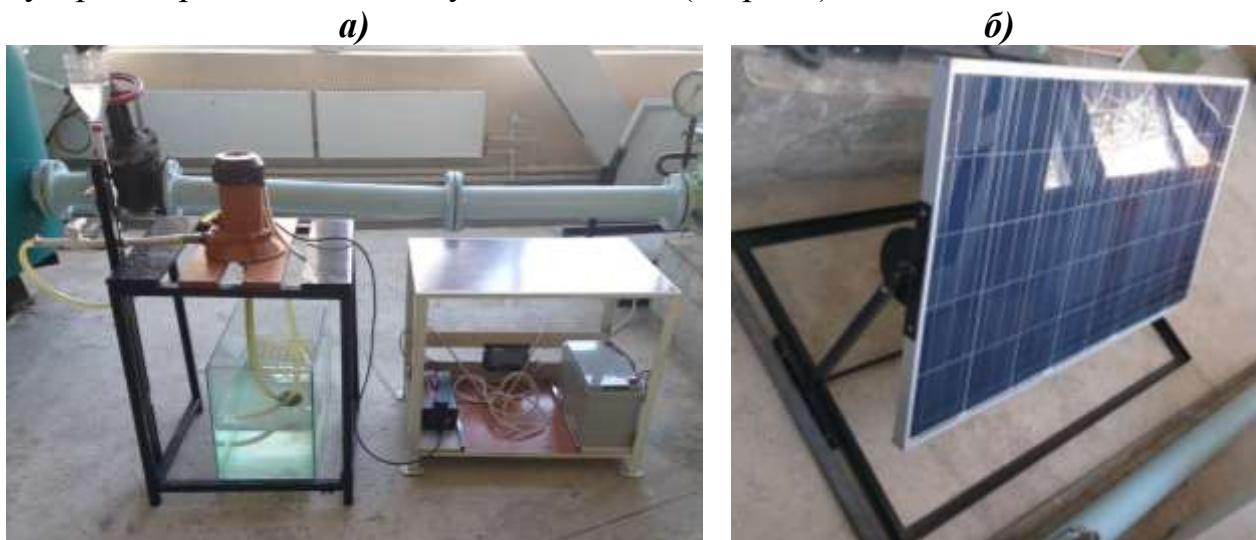
61-расм. Кафедра лабораториясига ўрнатилган 170 Вт ли «Агидель» қуёш насос энергоқурилмаси
