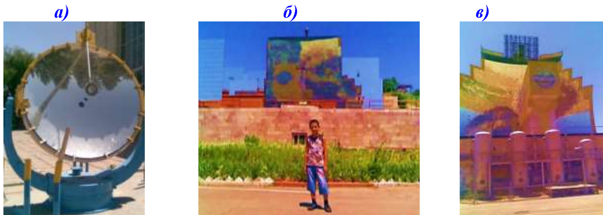
53-расм. Қуёш нурини иссиқлик энергиясига айлантирувчи мосламалар: а-анаънавий гелиостатлар; б- ясси гелиостатлар; в- гелиостатлардан келатган қуёш энергиясини йиғиб қуёш печига йўналтирувчи мослама.
