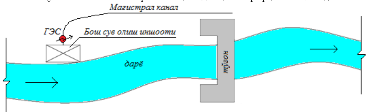
9.5-расм. Бош сув олиш иншоотидаги ГЭСнинг схемаси.
