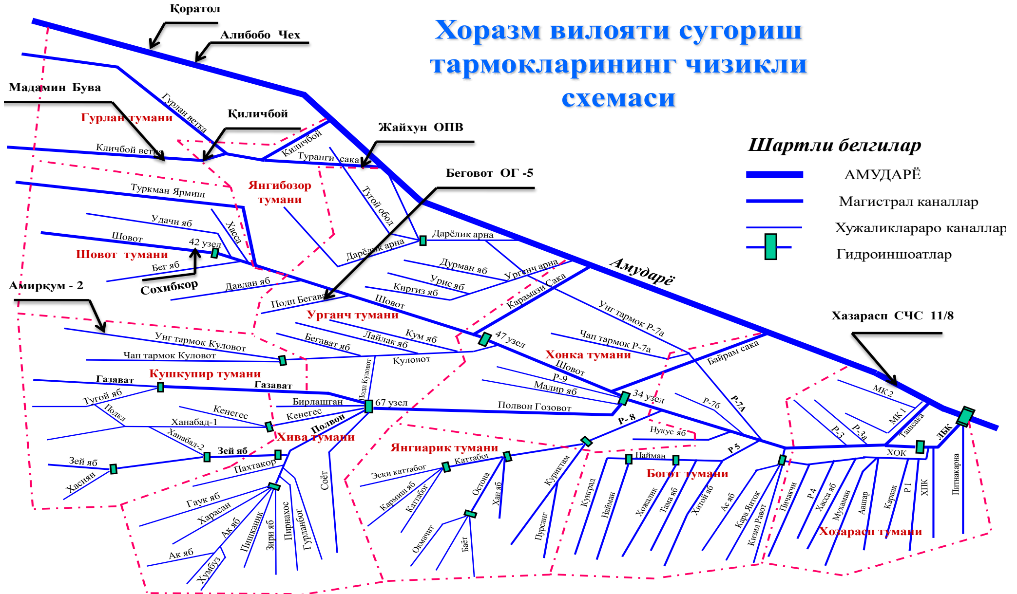
6.7-расм. Хоразм вилояти сугориш тармоқларининг чизикли схемаси.
