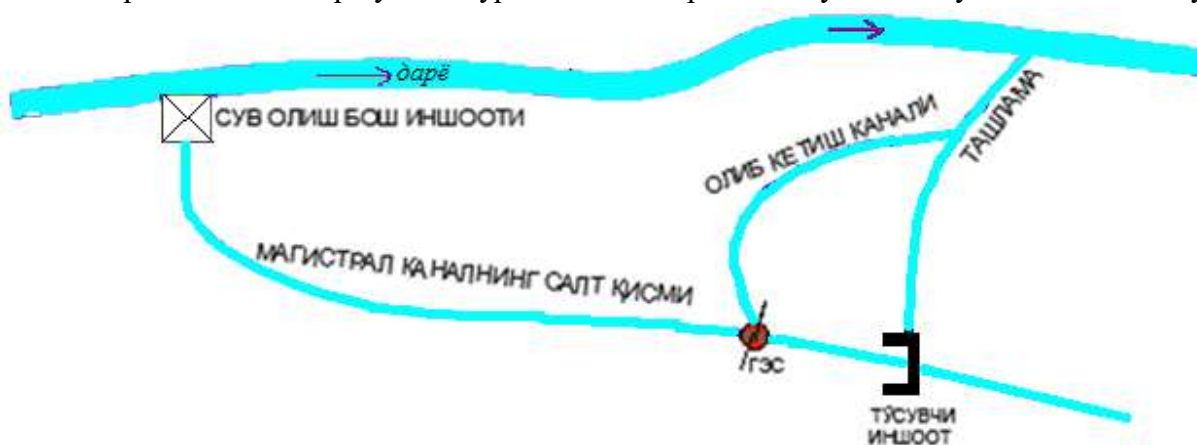
8.6-расм. Магистрал каналнинг нишаблиги дарё нишаблигидан кичик бўлган ( I_{\text{маг.канал}} < I_{\text{дарё}} ) ҳолатда энергия ишлаб чиқариш схемаси.
