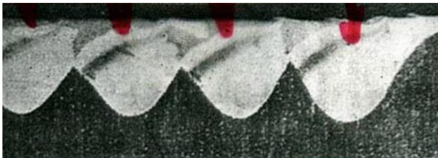
Лазерная закалка железоуглеродистых сталей упрочненный слой в стали Р6М5: сверху — на воздухе, снизу — в среде аргона (X100)
