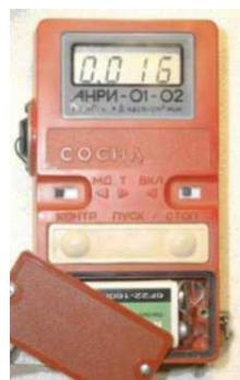
СБМ -20 Гейгер ҳисоблагичли «Сосна» дозиметр – радиометрининг умумий кўриниши
