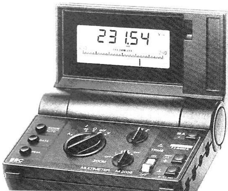
5 расм. Мултиметрнинг рақамли ва квазирақамли дисплейи
