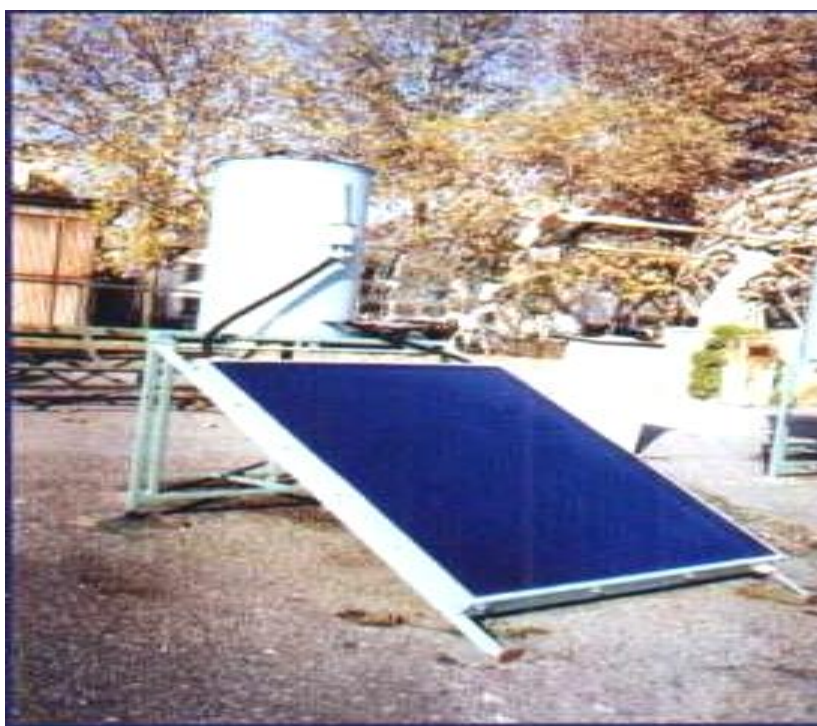
2.12- расм. Қуёш иситгичининг сатҳи 2 \text{ м}^2 ва иссиқ сув жамловчи бакининг ҳажми 140 л бўлган 2 контурли сув иситгич қурилма
