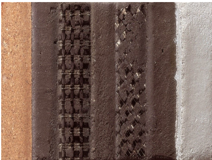
Икки сеткали углеводороддан арматураланган сувоқ қатлами таркиби
