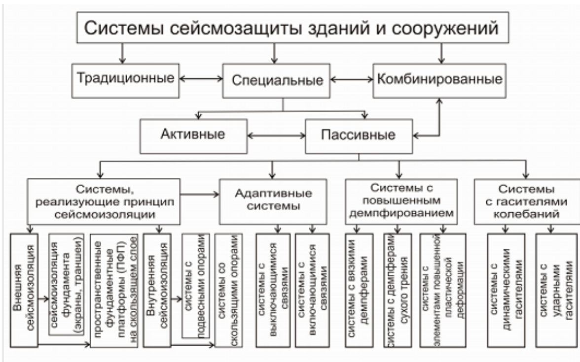
Рис.4.1. Классификация систем сейсмозащиты по принципу их работы
