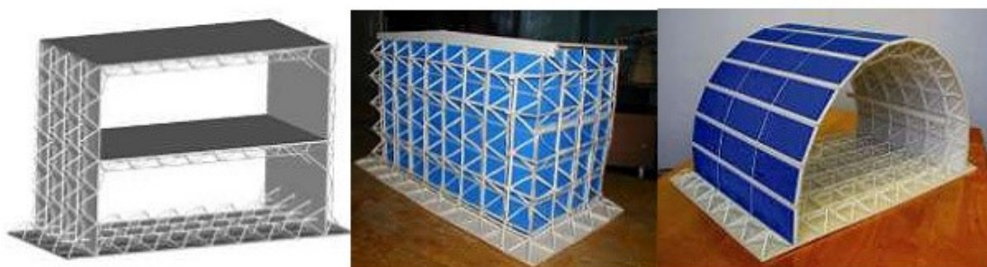
Рис.4.3. Примеры многосвязных зданий замкнутого типа, объединенных с пространственной фундаментной платформой
