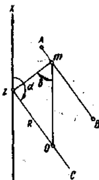
Рис. 33. Определение элементов залегания плоскости по двум направлениям с помощью линейной проекции
