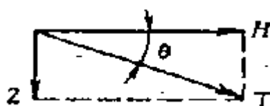
Рис.2. Горизонтальная и вертикальная составляющие магнитного поля земли
