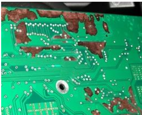
38-расм. ЭББ платасининг носоз кўриниши
