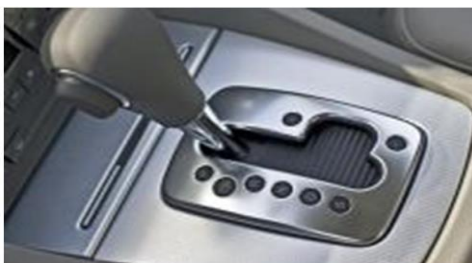
23-расм. Типтроник функцияли АУҚни бошқариш ричаги
