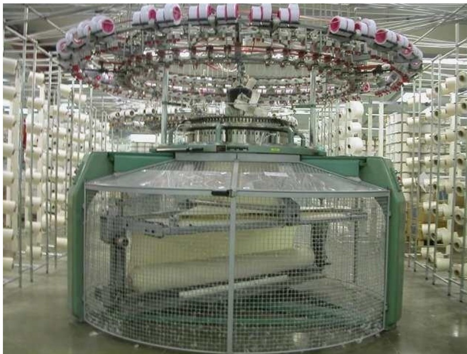
3.5-расм. Икки игнадонли жаккард трикотаж машинаси Mayer & Cil (Германия).
