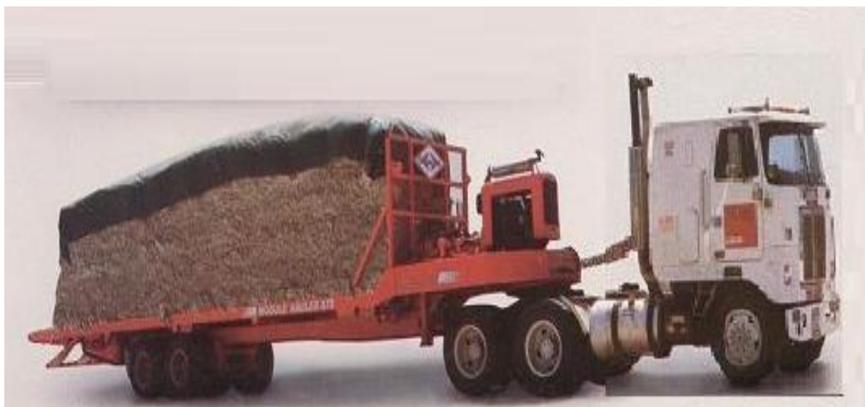
1.3-Расм. Пахта модулини ташувчи трейлер
