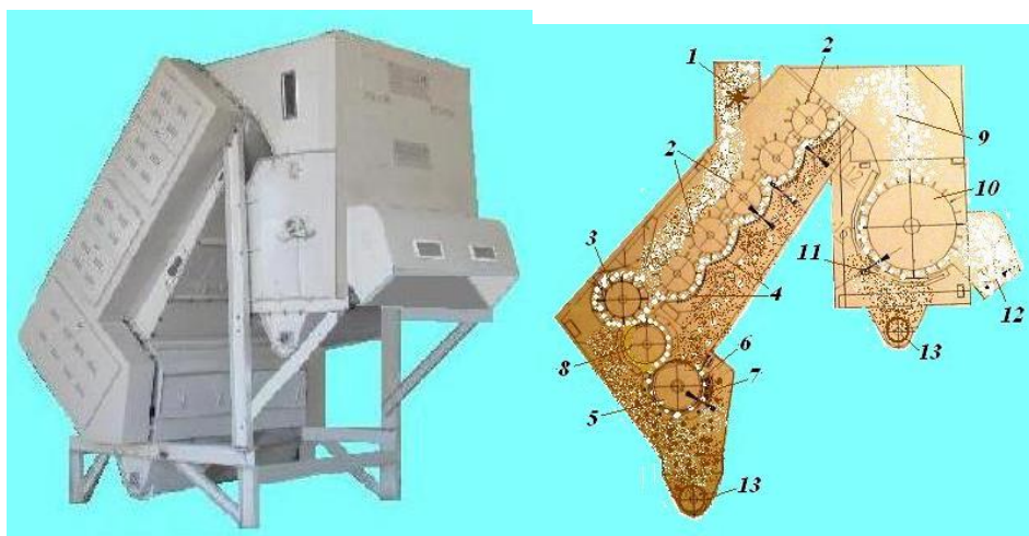
1.18-расм. MQZK-2400 русумли пахта тозалагичининг қирқими.
