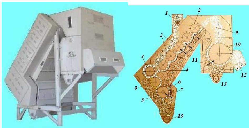
1.18-расм. MQZK-2400 русумли пахта тозалагичининг қирқими.
