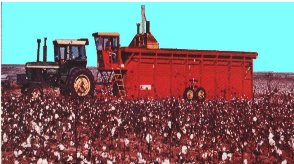
1.1-2.-расм. Модуль тайёрлагичда модульни тайёрлаш жараёни
