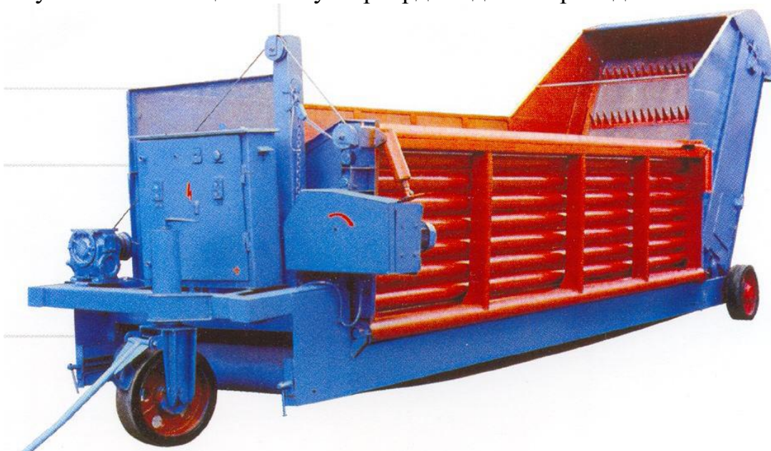
3-расм. ХПП-3 русумли чигитли пахтани тележкадан қабул қилувчи ролганли қурилманинг умумий қуриниши
