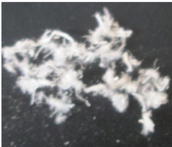
18-расм. Ишқорий усулда шолипоядан олинган целлюлоза толаларининг умумий кўриниши.
