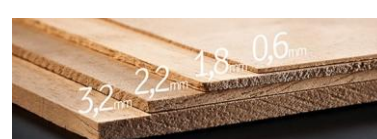
Майда тахталар ва қалин шпонлар (thin lumber, thick veneer)
