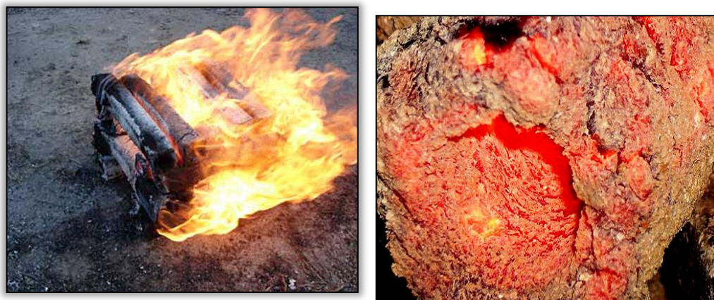
3.9-расм. Брикетларнинг алангаланиб (а) ва чўғланиб (б) ёниш жараёни.
