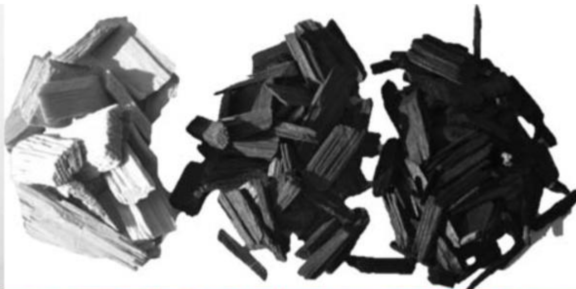
Табиий (куйдирилмаган) ёғоч бўлаклари (chapда), уларнинг куйдирилган ҳолати: оч-жигарранг (марказда) ва тўқ жигарранг (ўнгда), мос равишда 260 °C да 8 минут ва 285 °C да 16,5 минут мобайнида куйдирилган.
