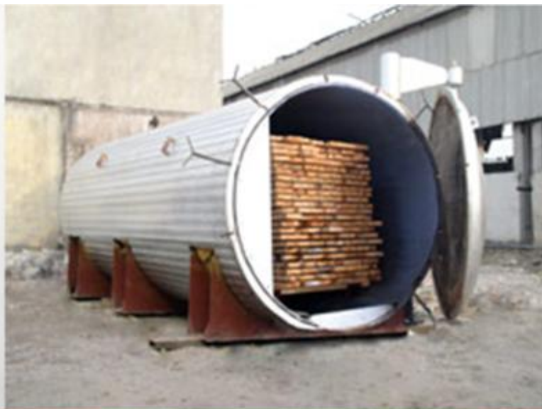
Термоёғоч олиш учун махсус герметик камера
