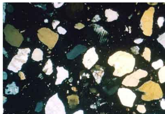
8-Расм Б . Цемент плиткасини микрорасмлари – қора рангдаги асосий масса – магнезиал цемент, йирик донали оқ рангли заррачалар – дала шпатлари, слюдалар таркибида тутган қум минераллари. катталаштириш даражаси 25^{\times} . Ўтказувчи нур, николлар кесишга холда.
