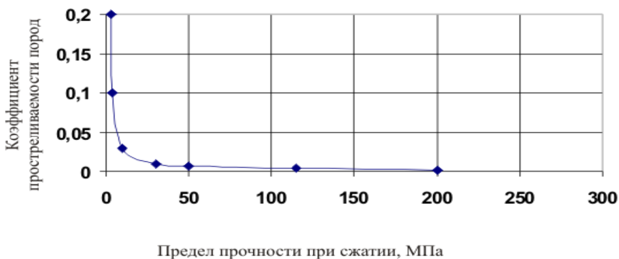
Рис. 2.4.17. график зависимости коэффициента простреливаемости пород от предела прочности при сжатии
