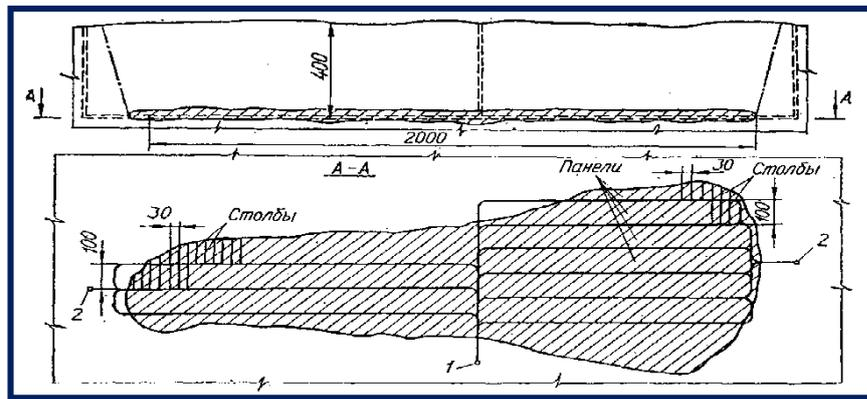
Рис. 2.1. Деление горизонтального месторождения на панели и столбы:
