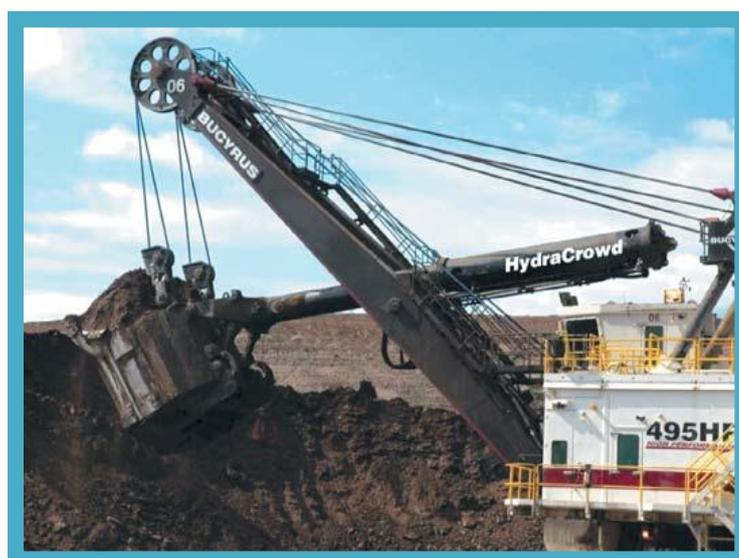
Рис. 2. Карьерная механическая лопата 495HF компании Caterpillar с гидравлическим напорным механизмом «HydraCrowd»
