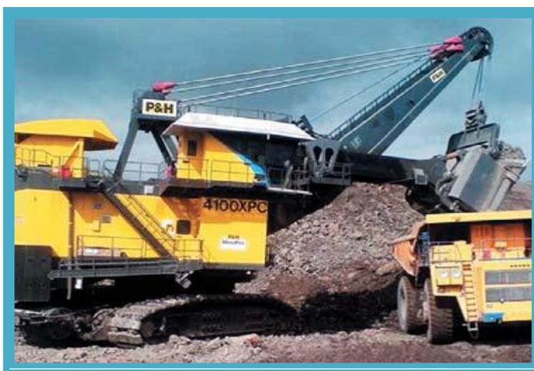
Рис. 6. Самая мощная модель карьерной механической лопаты с речным напором 4100ХРС компании P&H (а)
