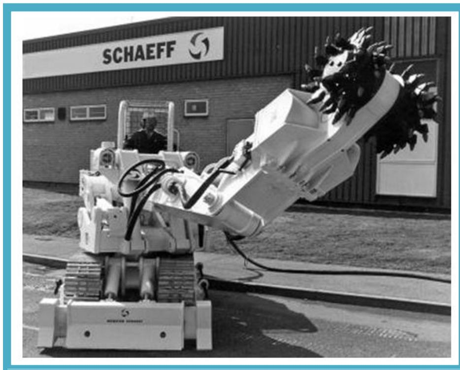
Рисунок 1.8. Наклон стрелы проходческого комбайна.
