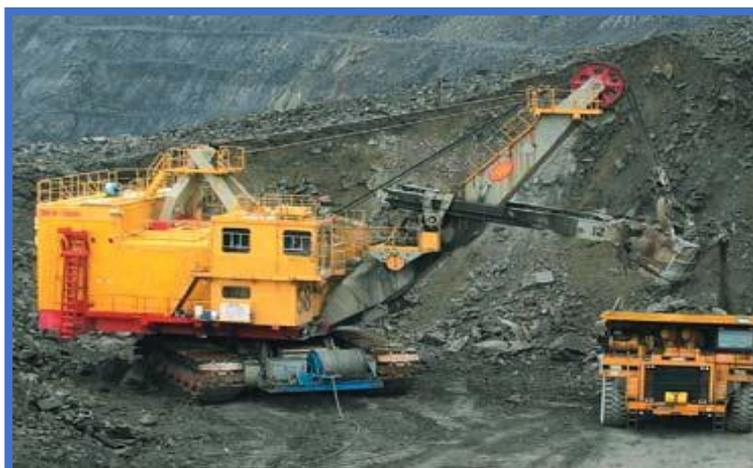
Рис.9. Экскаваторы типа прямая лопата с речным напором: а -ЭКГ-12 на разрезе Черниговский; б - ЭКГ-18 на Краснобродском разрезе УК «Кузбассразрезуголь»
