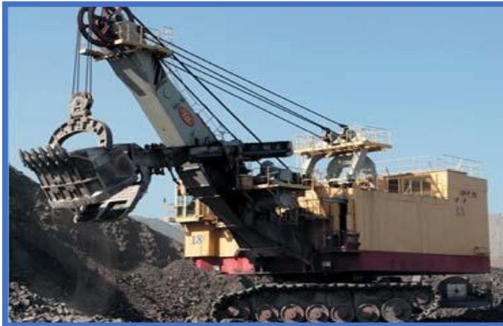
Современные экскаваторы Уралмашзавода оснащаются системами электропривода постоянного (ЭКГ-12А) или переменного тока (ЭКГ-18) со статическими преобразователями и цифровой системой управления, что позволяет снизить энергопотребление при высоком уровне КПД и надежности, а также системами -информационной, видеонаблюдения, автоматических защит рабочего оборудования и централизованной автоматической смазки.
