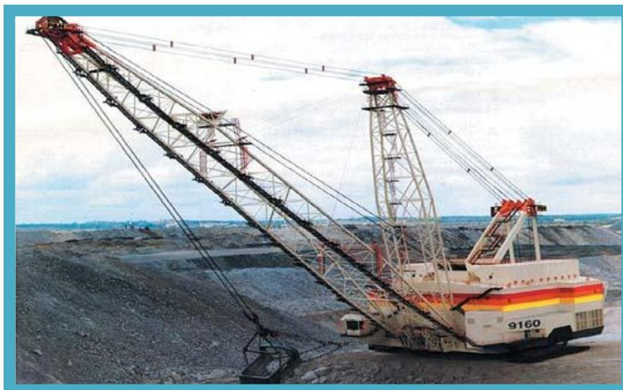
Рис. 15. Шагающий драглайн модель 9160 компании Surface Mining (P&H)
