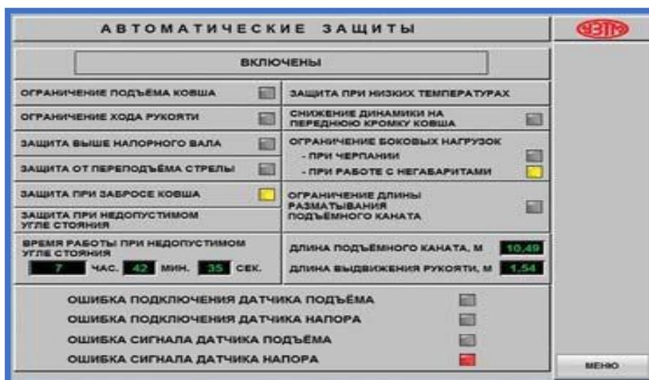
Рис.10 Экраны информационной системы экскаватора ЭКГ-12А: а – главный; б - автоматических защит рабочего оборудования
