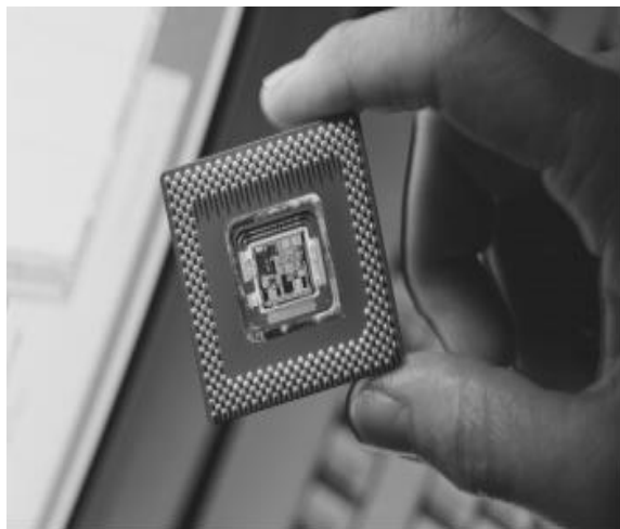
5-расм. Замонавий микропроцессор чипида электроник материаллар
