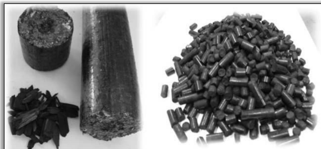
3.14-расм. Куйдирилган ёғоч, унинг зичланган брикетлари (чапда) ва пеллетлари (ўнгда).
