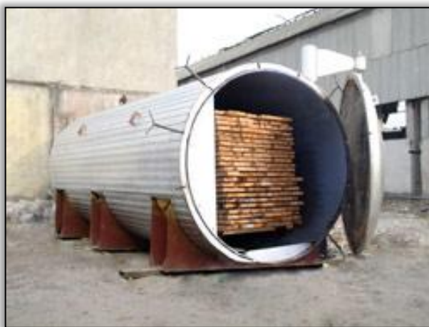
3.1-расм. Термоёғоч олиш учун махсус герметик камера
