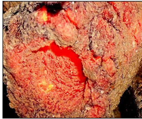
3.9-расм. Брикетларнинг алангаланиб (а) ва чўғланиб (б) ёниш жараёни.
